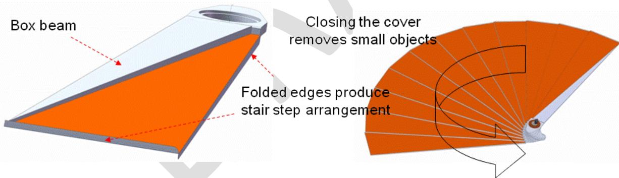
Fig.2.8-3. M1M3 Mirror Fan Blade.
