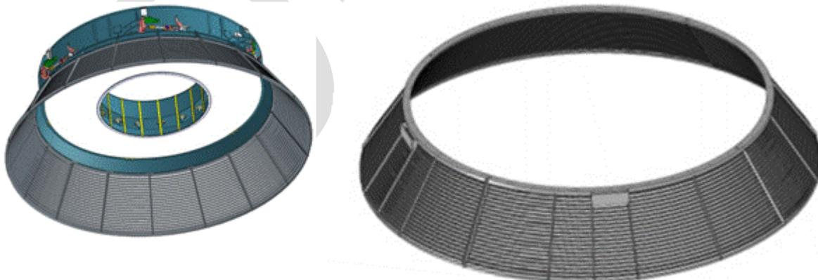
Figure 7.2.1.3-1: M2 Light Baffle.
